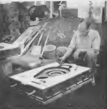
...reinforces the mold edges and cuts the gate ...reinforca e cantonan di e mold y corta e gate
